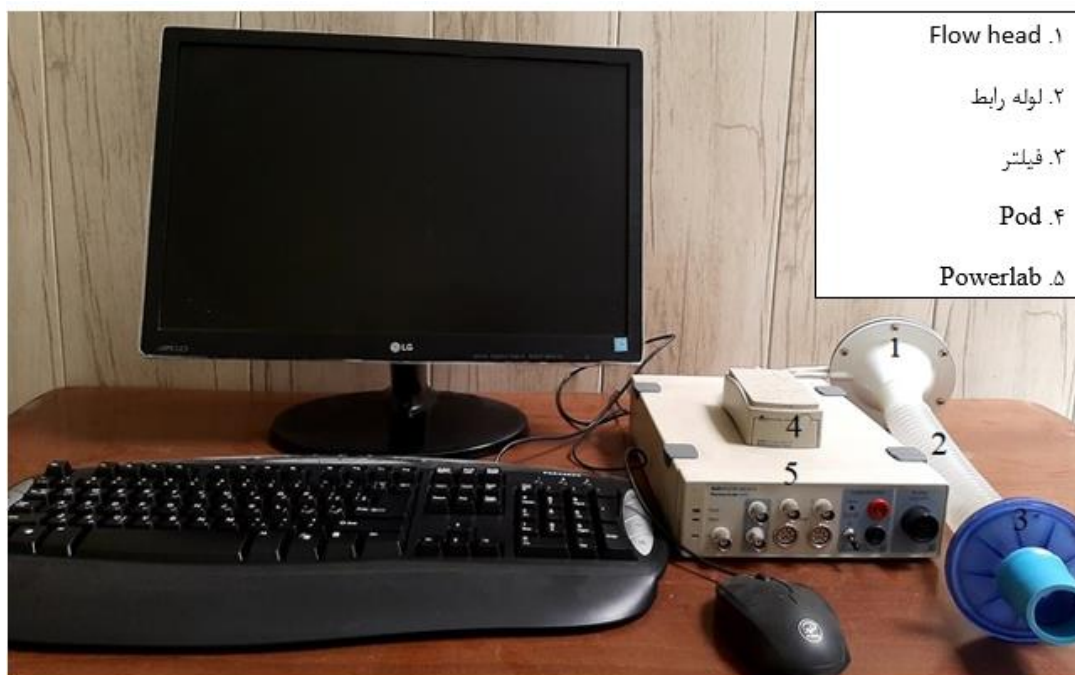
شکل 2-4. دستگاه پاورلب برای انجام اسپیرومتری
