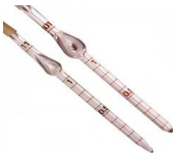
شکل 2-2. پیت ملانژور مخصوص شمارش گلبول های قرمز (سمت راست) و گلبولهای سفید (سمت چپ)
