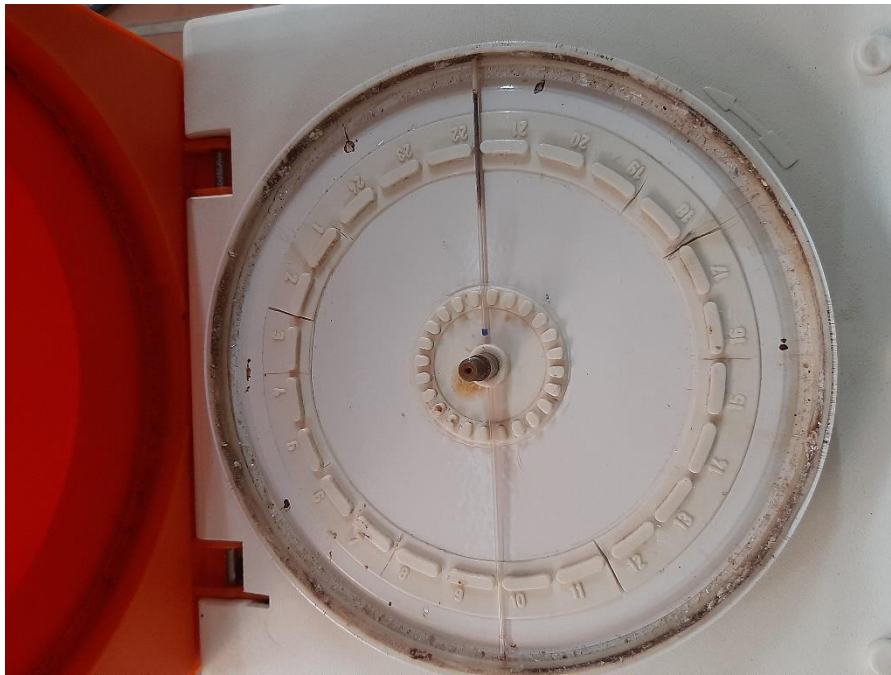
شکل 10-2. نحوه گذاشتن لوله موئینه در دستگاه میکروسانتریفوژ
