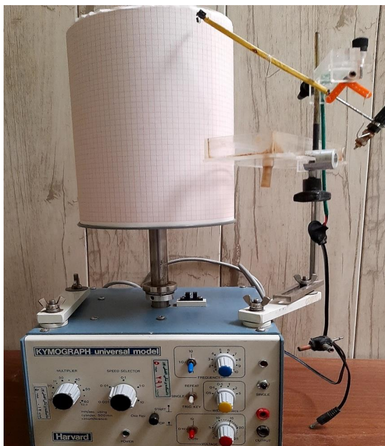
شکل 2-5. دستگاه کیموگراف که در پایین بخش محرکه الکتریکی و در بالا استوانه دوار نشان داده شده است.
